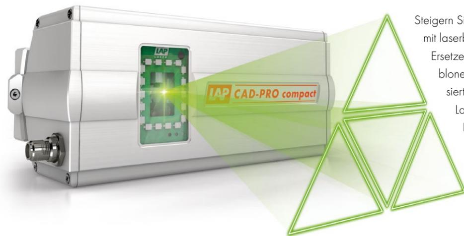
Steigern Sie die Effizienz Ihrer manuellen Fertigung mit laserbasierten Montageassistenzsystemen. Ersetzen Sie komplexe Anweisungen, Schablonen oder Messvorschriften durch visualisierte Informationen aus Ihren CAD-Daten. Laserlinien von galvanometerbasierten Projektionssystemen erreichen auf so gut wie allen Oberflächen hervorragende Präzision und Sichtbarkeit, selbst bei hellem Umgebungslicht.
