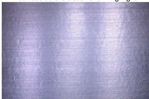
Oberfläche vor der Behandlung bei Streiflicht / Surface before treatment in highlight
