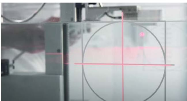
Alignement du fantôme d'eau à l'aide de lasers
