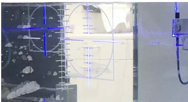
Alineación del fantoma de agua con ayuda de láseres
