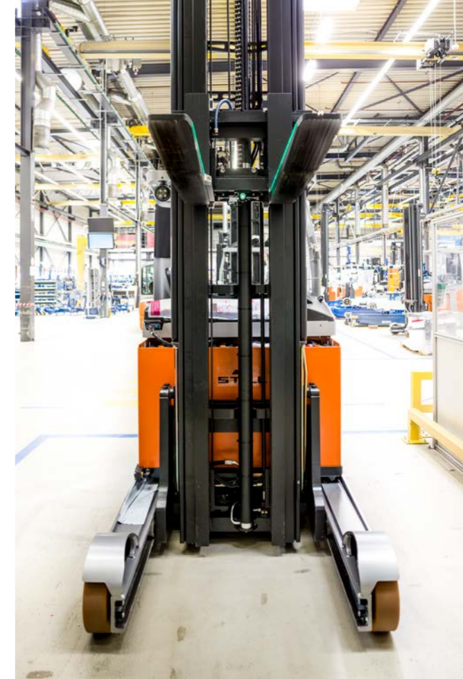
Láser de línea de LAP en la carretilla retráctil FM-X 20 HD de STILL. Esta eleva cargas de hasta 2000 kg a 13 metros de altura con una velocidad de elevación de hasta 0,50 m/s.
