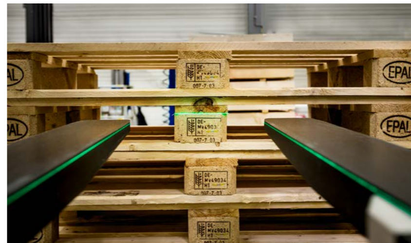
La línea de láser bien visible muestra al conductor con precisión a qué altura debe introducir los brazos de la horquilla en los huecos correspondientes de la paleta.
