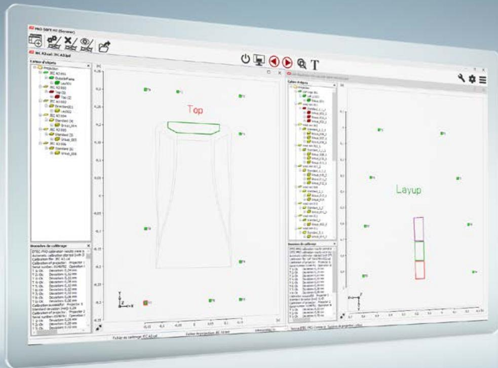
Le logiciel PRO-SOFT prend en charge toutes les fonctions de la caméra et le mode multitâche.
