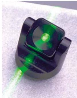
La capture des mires peut être manuelle, semi-automatique ou totalement automatique. Le calibrage manuel est nécessaire uniquement à l'installation du système, et se poursuivra automatiquement après la capture de quatre mires. Le fonctionnement semi-automatique est utilisé pour des installations mobiles. Ici il faut donner au maximum quatre mires. Sur les systèmes fixes, le calibrage est totalement automatique après l'installation du système.
