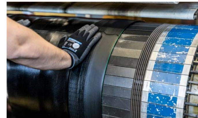
Changement de configuration en quelques minutes : la position précise de chaque pneumatique sur le tambour de fabrication est contrôlée par des lignes laser. La dernière génération de systèmes SERVOLASER SLX offre une visibilité encore meilleure grâce aux diodes laser vertes.
