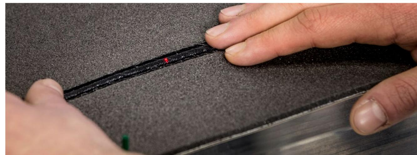
Die Punktlaser markieren an mehreren Stellen den Verlauf der Ziernaht auf der Rückseite des Dekors. So ist ein schnelles und sicheres Positionieren möglich.
