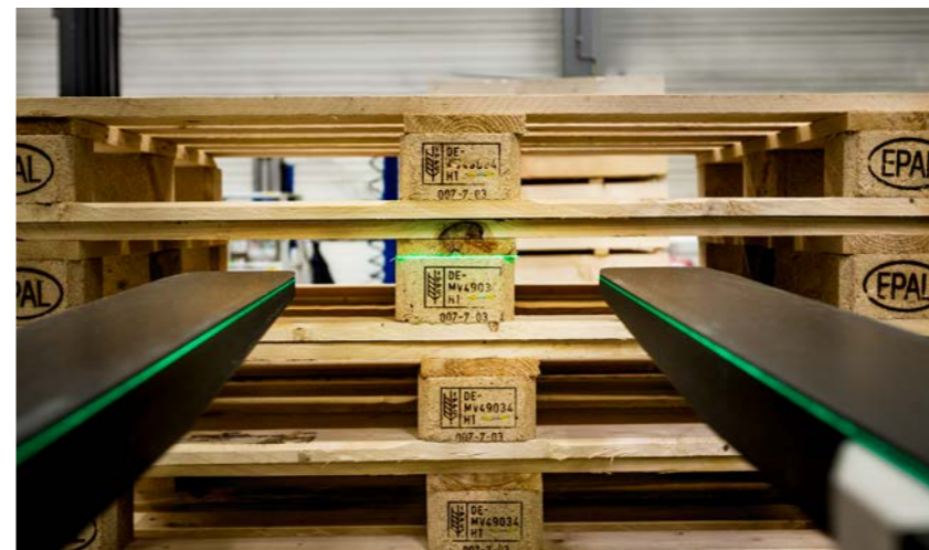
Die gut sichtbare Laserlinie zeigt dem Fahrer präzise an, auf welcher Höhe er die Gabelzinken in die Einfahrtaschen der Palette fahren muss.
