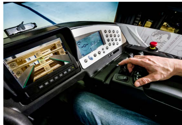
Die Situation klar im Blick: Auf dem Monitor sieht der Bediener, wann er die exakte Zielposition erreicht hat.
