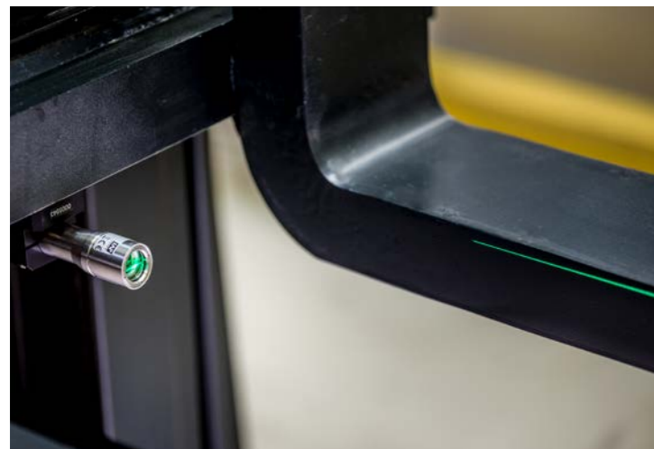
Der Positionierlaser XtrAlign HY mit grüner Laserdiode ist zwischen den Gabelzinken am Gabelträger montiert.
