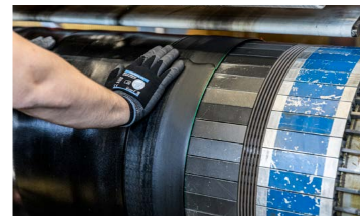
Wechsel im Minutentakt: Die präzise Position jeder Reifenlage auf der Reifenaufbautrommel wird anhand der Laserlinien kontrolliert. Die jüngste SERVOLASER Generation SLX sorgt dabei dank grüner Laserdioden für noch bessere Sichtbarkeit.
