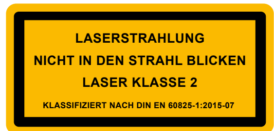
Abbildung 8: Beispiel eines Laserwarnschildes nach EN 60825-1. Die Laserklasse muss als Hinweis ebenfalls am Laser deutlich sichtbar sein.
