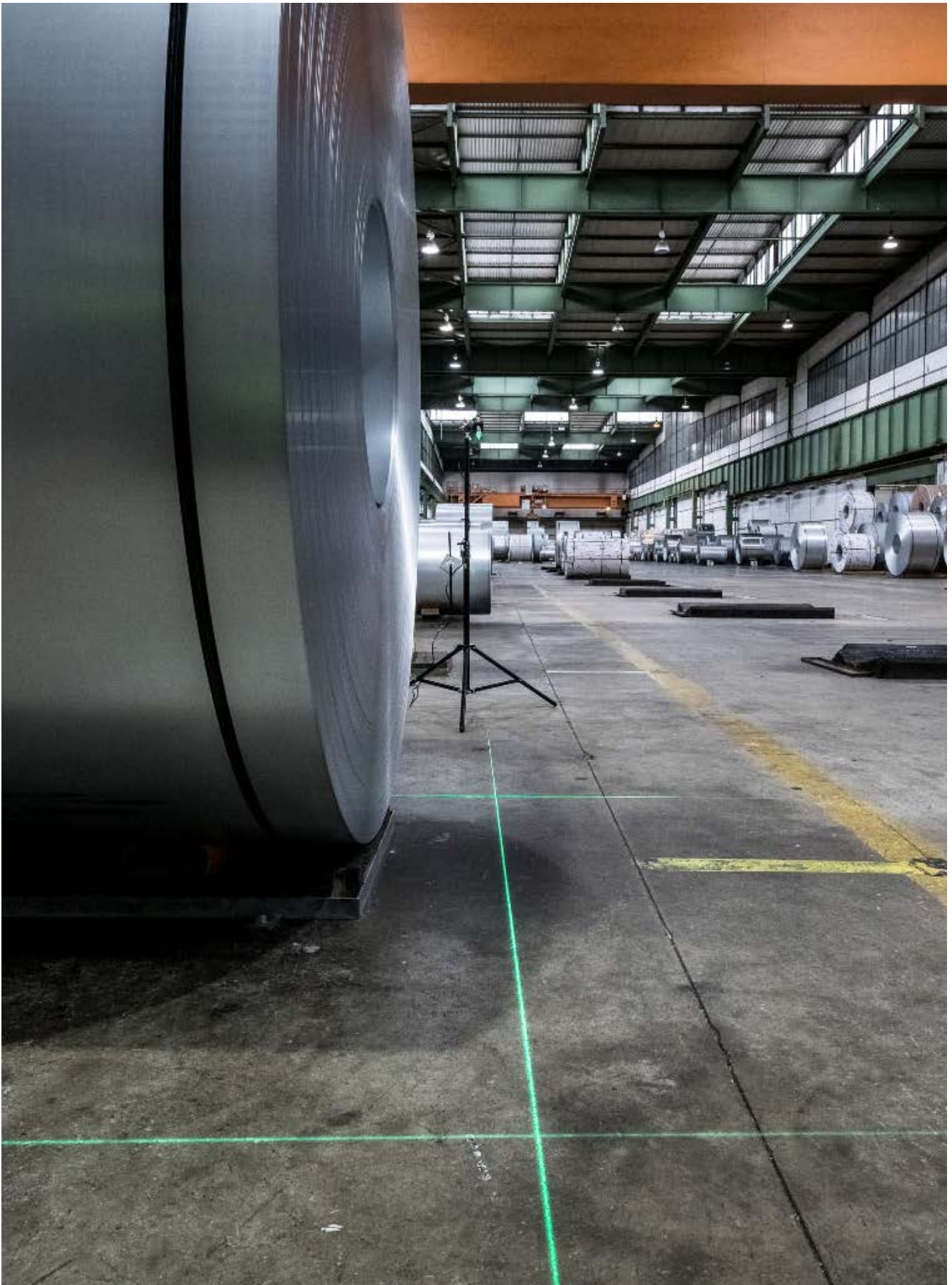
Linienlaser erzeugen permanent sichtbare farbige Markierungslinien, die auch in stark belasteten Umgebungen nicht an Sichtbarkeit verlieren.
