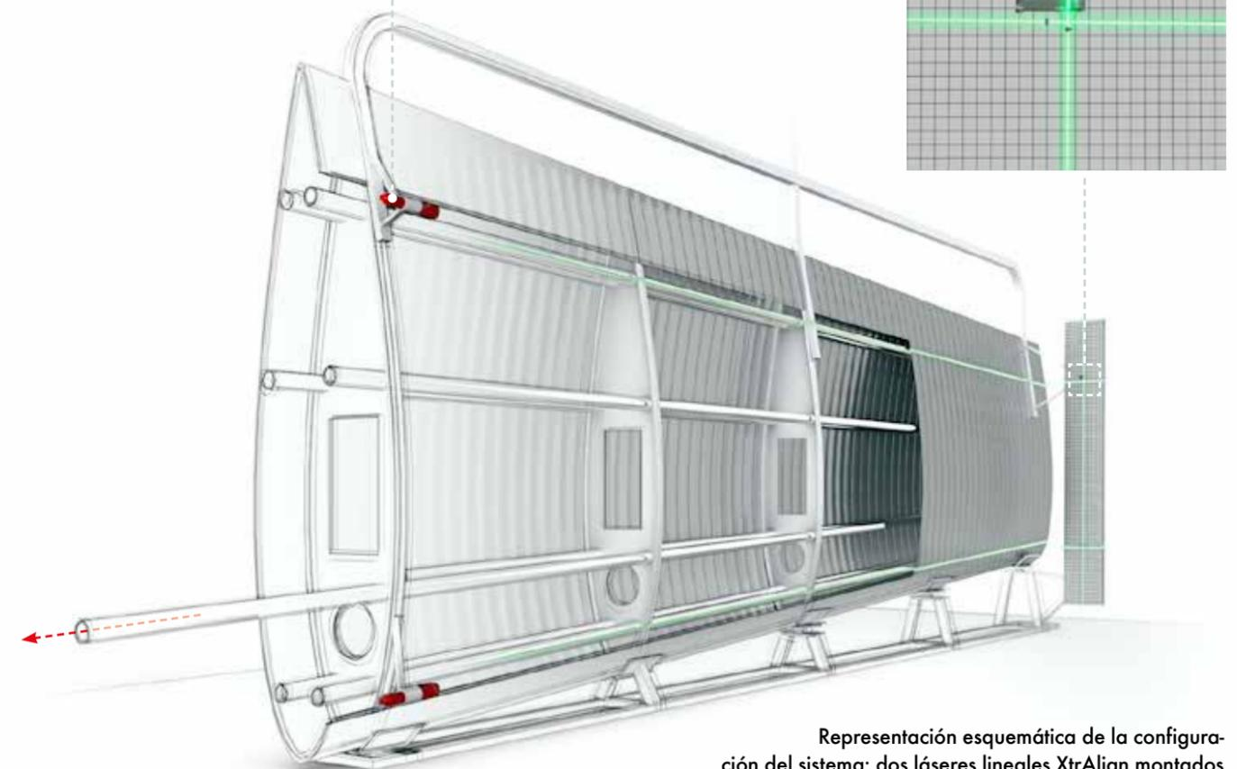
Representación esquemática de la configuración del sistema: dos láseres lineales XtrAlign montados uno en la parte superior y otro en la parte inferior del ala indican mediante las cruces de láser proyectadas si los largueros se encuentran en la posición exacta.
