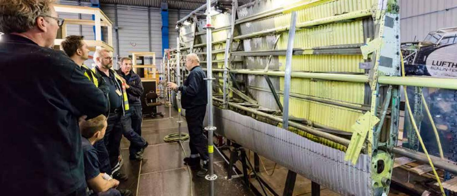
En el hangar de la base de Hamburgo de Lufthansa, el Ju se equipó con seis largueros nuevos. Cada larguero tiene una longitud de 11 metros y está compuesto por entre seis y ocho segmentos de tubo que se van estrechando conforme se acercan al extremo del ala.
